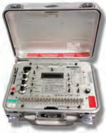
la valise de test permet de tester les plateformes de régulation des moteurs ou turbines
